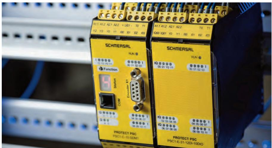
▲ Sicherheits(kompakt)steuerungen wie die Protect PSC1-Serie von Schmersal erlauben größere Freiheiten bei der Integration der Zuhaltfunktion in den Prozess.
