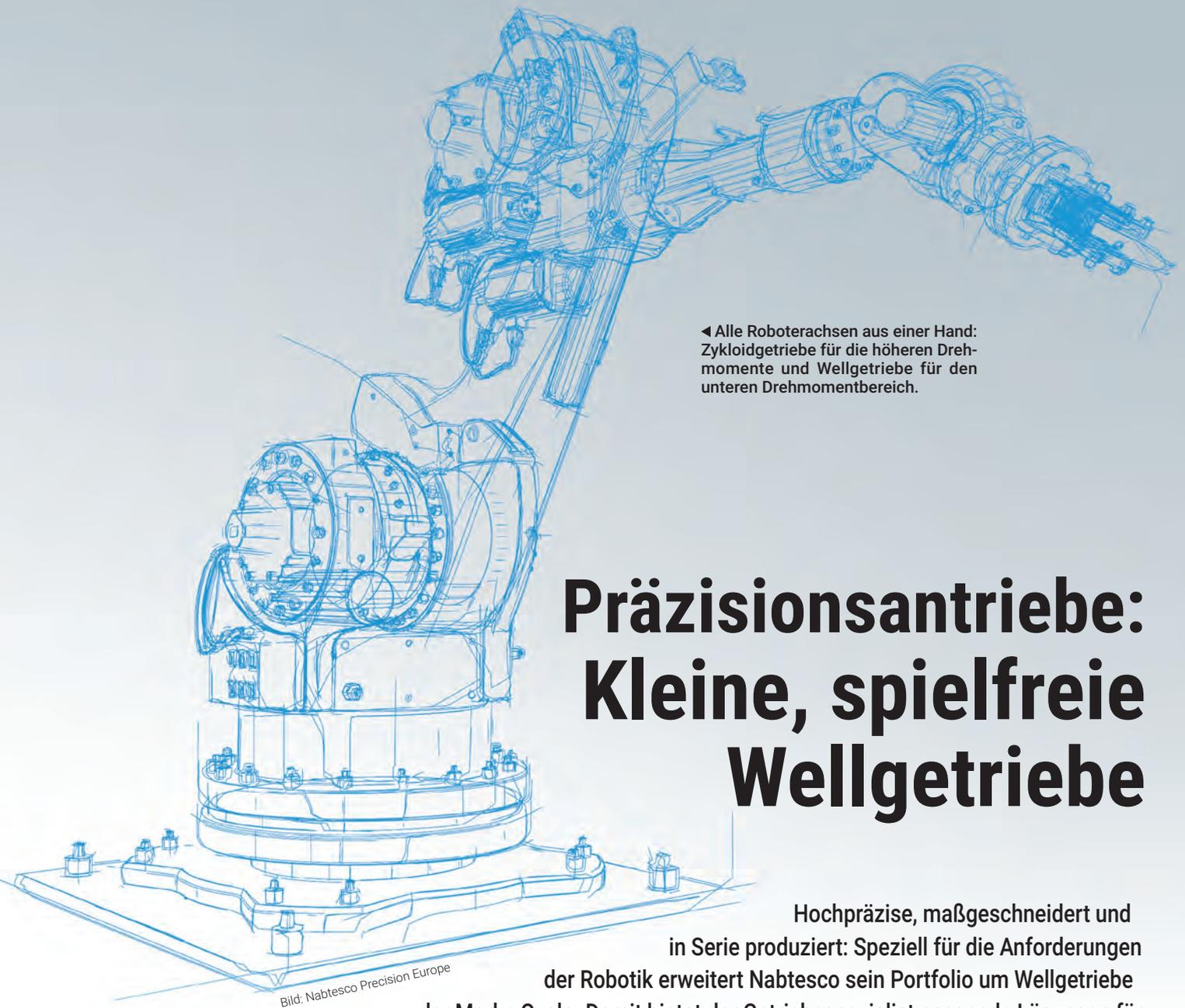
◀ Alle Roboterachsen aus einer Hand: Zykloidgetriebe für die höheren Drehmomente und Wellgetriebe für den unteren Drehmomentbereich.
