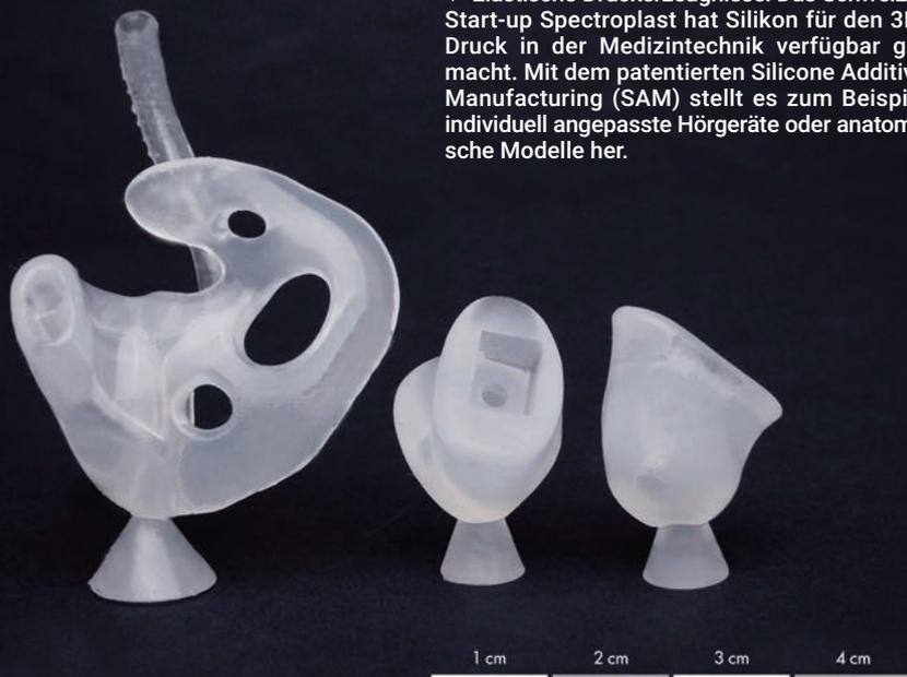
▼ Elastische Druckerzeugnisse: Das Schweizer Start-up Spectroplast hat Silikon für den 3D-Druck in der Medizintechnik verfügbar gemacht. Mit dem patentierten Silicone Additive Manufacturing (SAM) stellt es zum Beispiel individuell angepasste Hörgeräte oder anatomische Modelle her.
