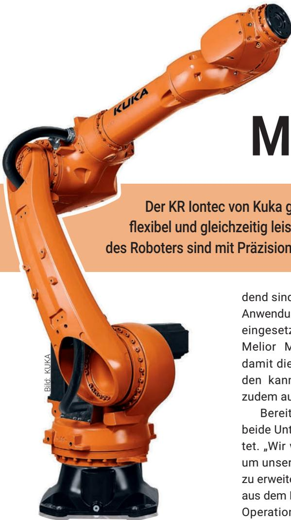
▲ Alle sechs Achsen des KR Iontec sind mit den Präzisionsgetrieben von Melior Motion ausgestattet.
