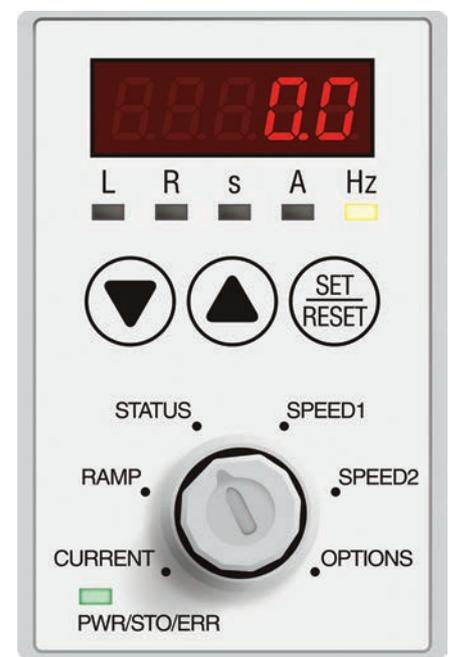
kanalige Abschaltung durchzuführen. Somit erreicht das Gerät die Sicherheitskategorien SIL3, PLe und Kat.4 – und das mit einem geringen Bauraum.
