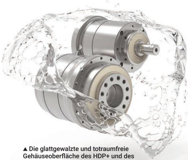
▲ Die glattgewalzte und tottraumfreie Gehäuseoberfläche des HDP+ und des HDV minimiert Anhaftungsmöglichkeiten für Produktreste und erleichtert das rückstandsfreie Abwaschen und Ablaufen von Reinigungs- und Desinfektionsmedien.
