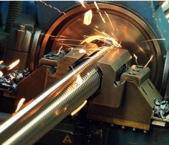
▲ Das Hartwirbeln ist eine spanabhebende Fertigung, bei der die Kugellaufbahnen in das bereits gehärtete und präzisionsgeschliffene Spindelmaterial gewirbelt werden.
