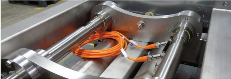
▲ Die wartungsfreie automatische Bahnkantenregelung mit Drylin Trapezgewindemutter und Drylin R-Linearfolien schafft die Voraussetzung für die Verarbeitung diverser Folienqualitäten.
