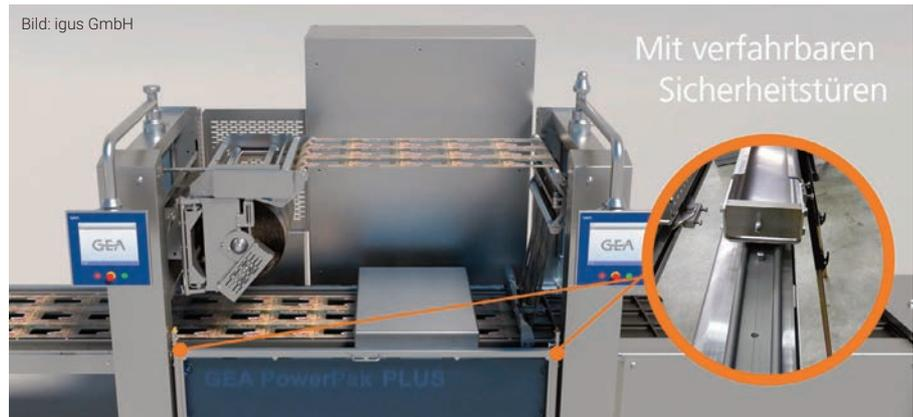
▲ Die großflächige Schiebetür (siehe Bild 1) ersetzt alle alten Haubenlagerungen. Geöffnet und geschlossen wird sie mithilfe von Drylin W-Hybridlinearrollenlagern.
