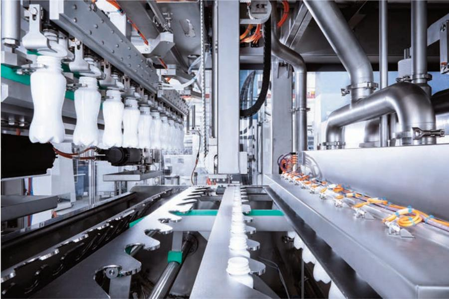
▲ Der neue lineare Aseptik-Block InnoPET BloFill ABF von KHS ist für die Abfüllung von Milch, Milchmixgetränken sowie Säften, Smoothies und Eistee in PET-Flaschen mit Volumina zwischen 250 Milliliter und 2 Liter ausgelegt.
