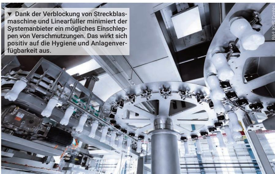
▼ Dank der Verblockung von Streckblasmaschine und Linearfüller minimiert der Systemanbieter ein mögliches Einschleppen von Verschmutzungen. Das wirkt sich positiv auf die Hygiene und Anlagenverfügbarkeit aus.
