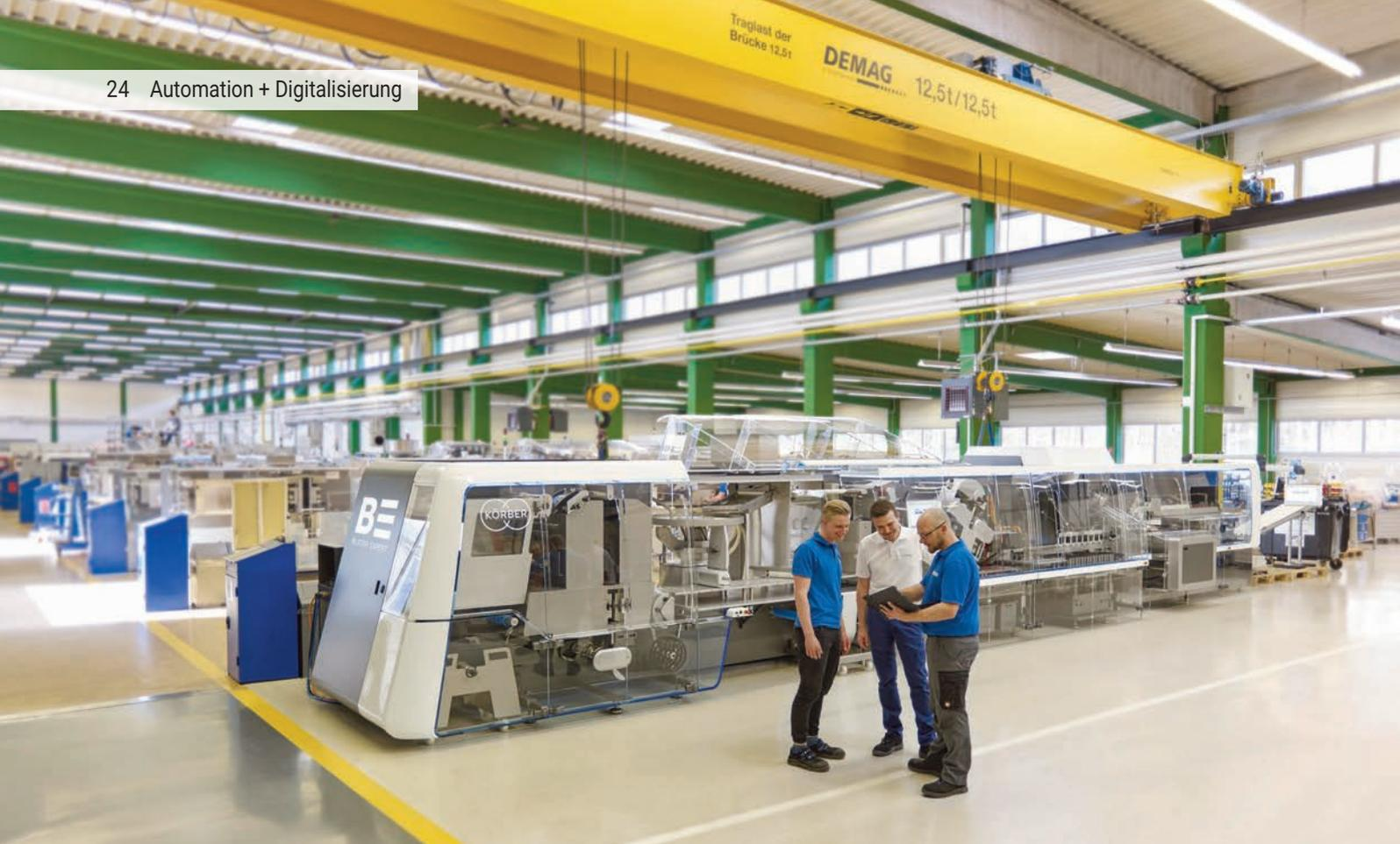
▲ Mediseal hat ein Blister- und Kartoniermaschinen-Portfolio auf Basis eines modularen Baukastensystems entwickelt. Die Blister-Expert-Plattform erlaubt es, entsprechend der jeweiligen Kundenanforderung die passende Maschine aus einer Vielzahl bereitstehender Module zu konfigurieren und im Anschluss sofort aus den vorproduzierten Bausteinen zu fertigen.
