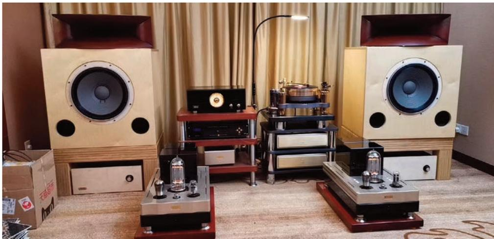
◀ HiFi-Vorführraum der Shenzhen BaiRuiKe Technology, in dem pneumatische Luftfederelemente den Aufbau wirksam von den aus einem Nachbarbetrieb kommenden Schwingungen entkoppeln.
