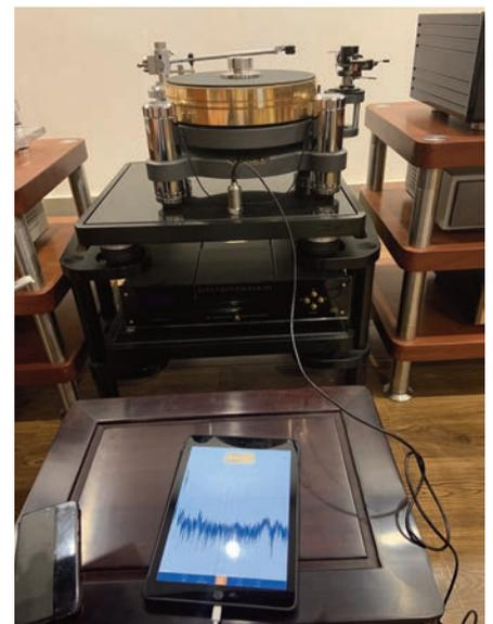
▲ Zusammen mit den niederfrequenten pneumatischen Luftfederelementen lieferte ACE auch die App VibroChecker und die mobile, kostengünstige Lösung zur Schwingungsmessung. Diese macht aus einem iPhone mit Hilfe eines externen USB-Sensors ein professionelles Messgerät.
