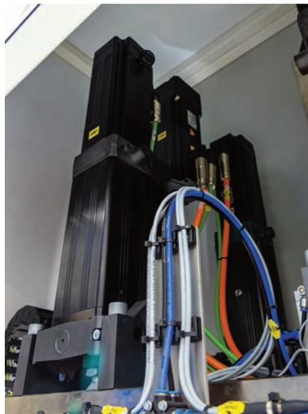
▲ Jedes Werkzeug ist mit jeweils sechs Elektrozyindern ausgestattet. Zwei Zylinder der Baureihe CMSMB71 realisieren die Schließbewegung des Werkzeugs und erzeugen die Vorspannung, vier weitere Elektrozyylinder der Baureihe CMSB71 bewegen die Platten einzeln und im Verbund, vollziehen die Arbeitshübe und fahren die Zwischenpositionen an.
